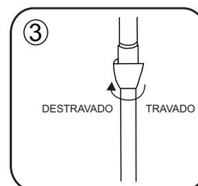
Para lavar o refil, destrave a trava localizada no cabo (figura 3) e encaixe o tampo do esfregão com o refil na parte interna do balde. Após, pressione o cabo para baixo (figura 4). Para retirar o excesso de água do refil, mantenha a trava do cabo destravada (figura 3) e coloque o refil no sistema de centrifugação. Após, pressione o cabo para baixo (figura 5), de modo que o refil gire 360°. Para retirar o refil, pise no mesmo e puxe o cabo (figura 6).
